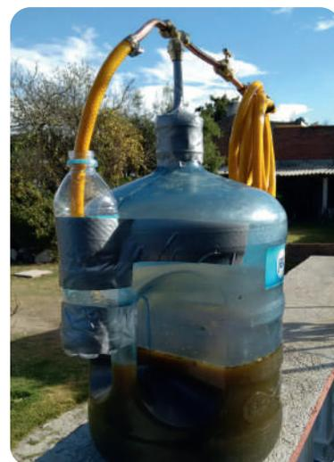
Exemple de biodigesteur construit par les élèves pendant le projet.
